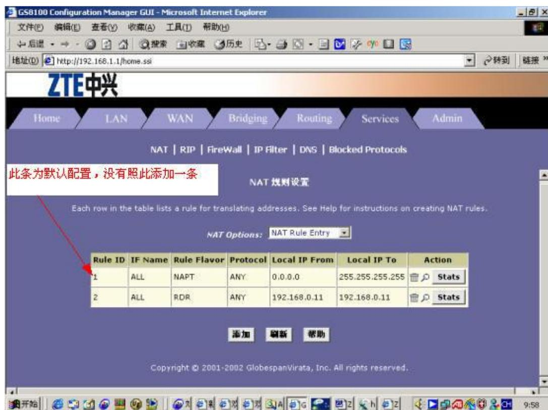
5、**关键**点击“**添加**”，在弹出窗口中如下填写：附图有几种端口的设置方法
