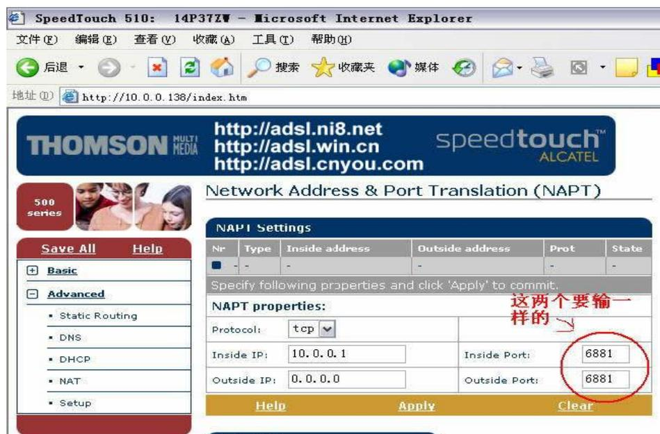
4、按了 Apply 后，我们刚才设置的端口映射就出现在 NAPT Settings 下方。此时若要再进行端口映射，可以点 New，步骤与（3）一样。
