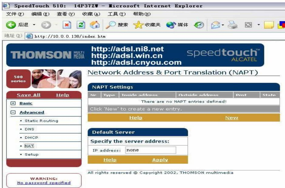
3、需要注意的是，Protocol 一定要选 Tcp，Inside IP 填 10.0.0.1，Outside IP 填 0.0.0.0，Inside Port 和 Outside IP 要填一样的，如 WEB=80、VA= 6802 按 Apply 确认。
