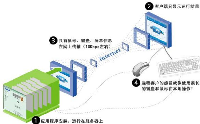
VA 是构建在 Microsoft Windows Remote Desktop Service ( RDS ,原 Teminal Service )基础之上 ,并提供了大量扩展的增强功能 ,用户可以使用各种终端设备 ,以会话共享的方式 ,访问运行在 Windows 2003/2008 服务器上的应用程序或共享桌面。每个用户仅仅能够看到自己的会话 ,不同用户之间的会话是隔离的。应用程序在数据中心服务器上执行 ,显示屏幕和键盘等输入通过网络进行传输 ,没有真正的业务数据在网络传输。
